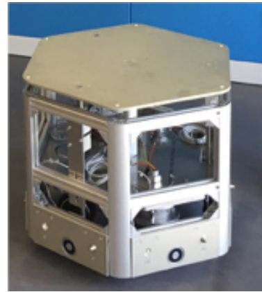
Abbildung 1: Selbstentwickelter autonomer Transportroboter des EmRoLab
